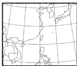
圖6-本研究模式設定的單層巢狀網格，水平網格點數為301x253，網格間距為15km。
